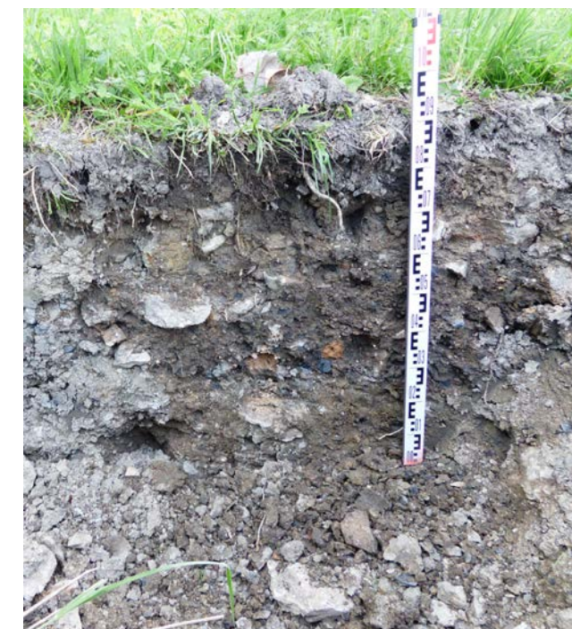
Sondage 11. Argile rapportée chargée en matériaux de démolition Photo : A. Allimant-Verdillon
