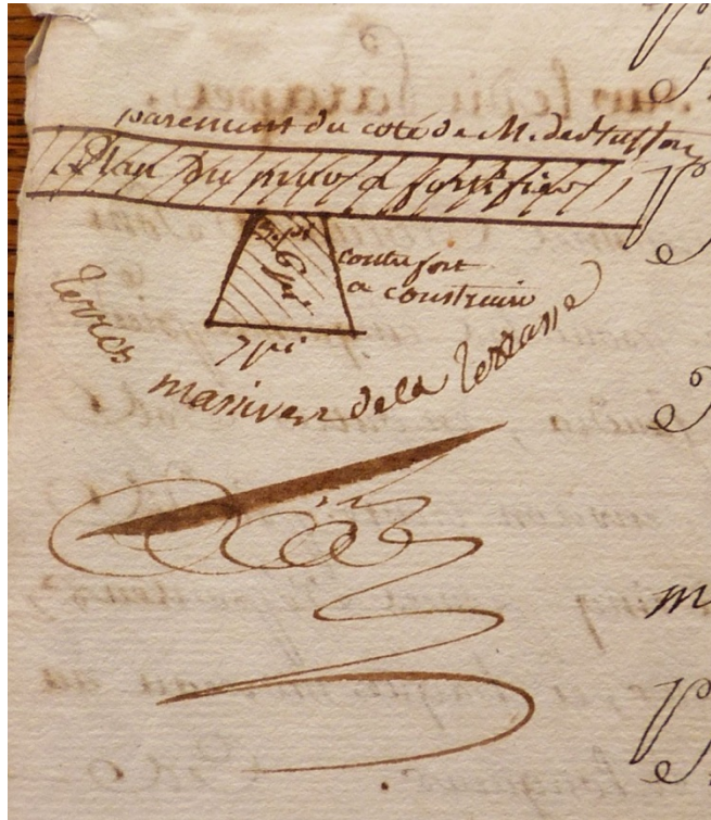
Système d'ancrage du mur de terrasse du jardin de la cure proposé par les experts. 8 avril 1774. ADCO C 1326
