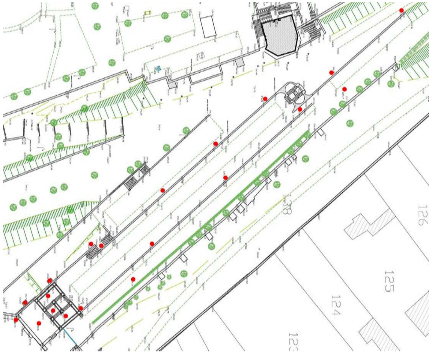
Après 2001. Mise en place de puits perdus et drainages le long des terrasses Est
